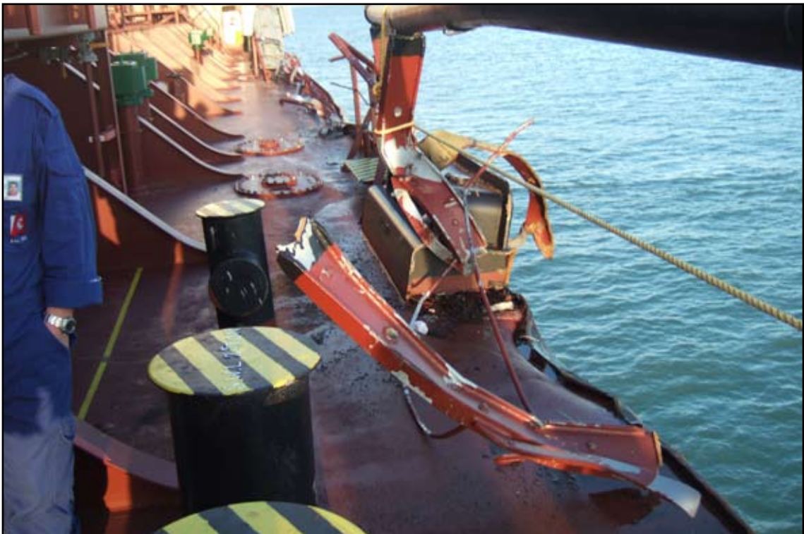
Deck edge damage
