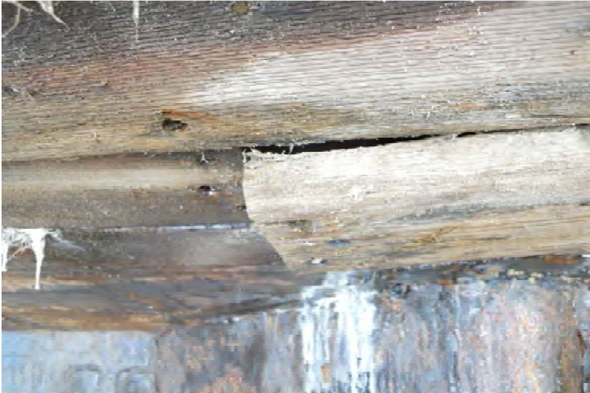
11 - Plank 5 starboard side sprung at butt.JPG
